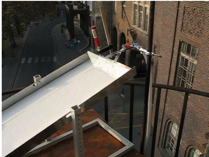
4. ábra Kerámiapapíron rögzített fotokatalizátor alkalmazása napsugárzással történő megvilágítás mellett áramlásos reaktorban
