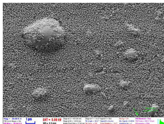
14. ábra: A 900 °C-on hőkezelt n-GaN/Ti/Cu/Al kontaktus FESEM képe.
