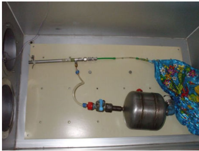
6. ábra: Hővezető képesség alapján történő szelektivitás meghatározás
