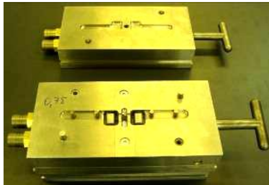
23. ábra A legyártott szerszám betétek (fenn álló oldali, lenn mozgó oldali)
