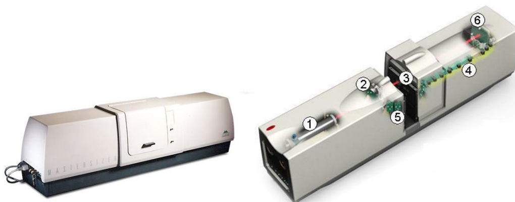
7. ábra Malvern Mastersizer 2000 szemcsevizsgáló készülék 1) lézer, 2) kék fényforrás, 3) mérési zóna, 4) oldalfény detektor, 5) háttér detektor, 6) fókusz detektor (Forrás: www.malvern.com )
