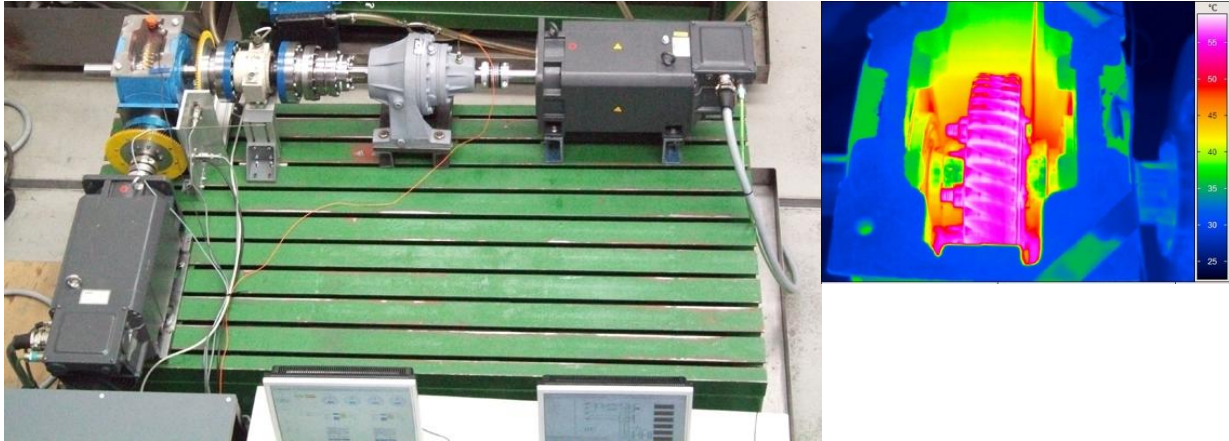
11. ábra. A felépített hajtástechnikai vizsgálóberendezés fényképe és a mérés közben termokamerával készült felvétel a vizsgált hajtóműről
