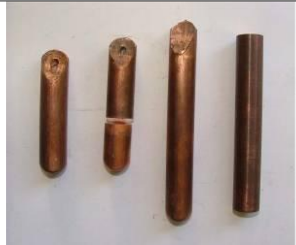
2.2. ábra. Könyöksajtoló berendezésen egyszerűen átsajtolt OFHC-réz próbadarabok, valamint a kísérletekhez szolgáló, kiinduló rúd
