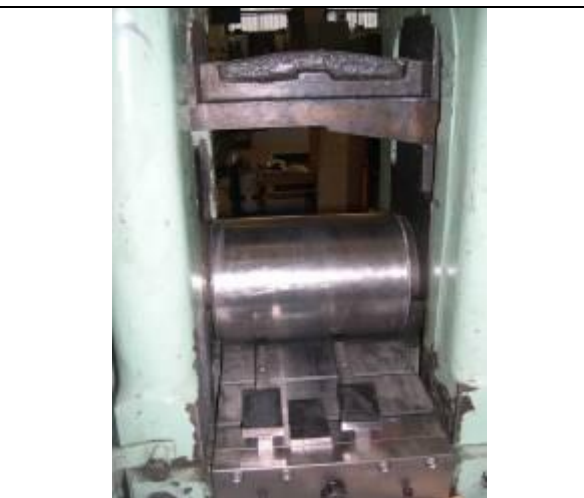
2.5. ábra. Laboratóriumi körülmények között végzett hengerlési kísérlet berendezése a különböző vastagságú,
