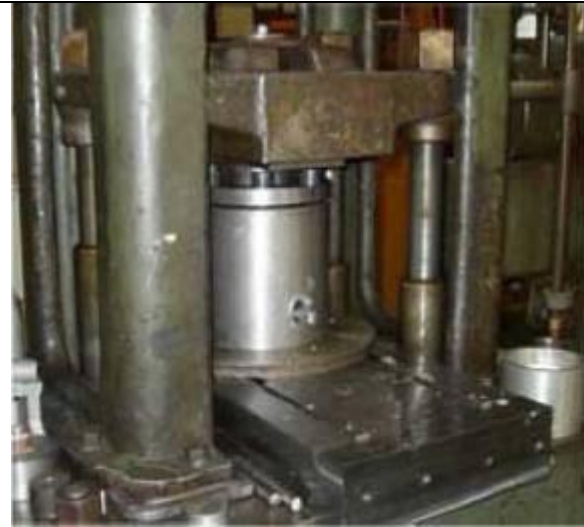
2.1. ábra. A kísérletekhez használt könyöksajtoló berendezés működés közben
