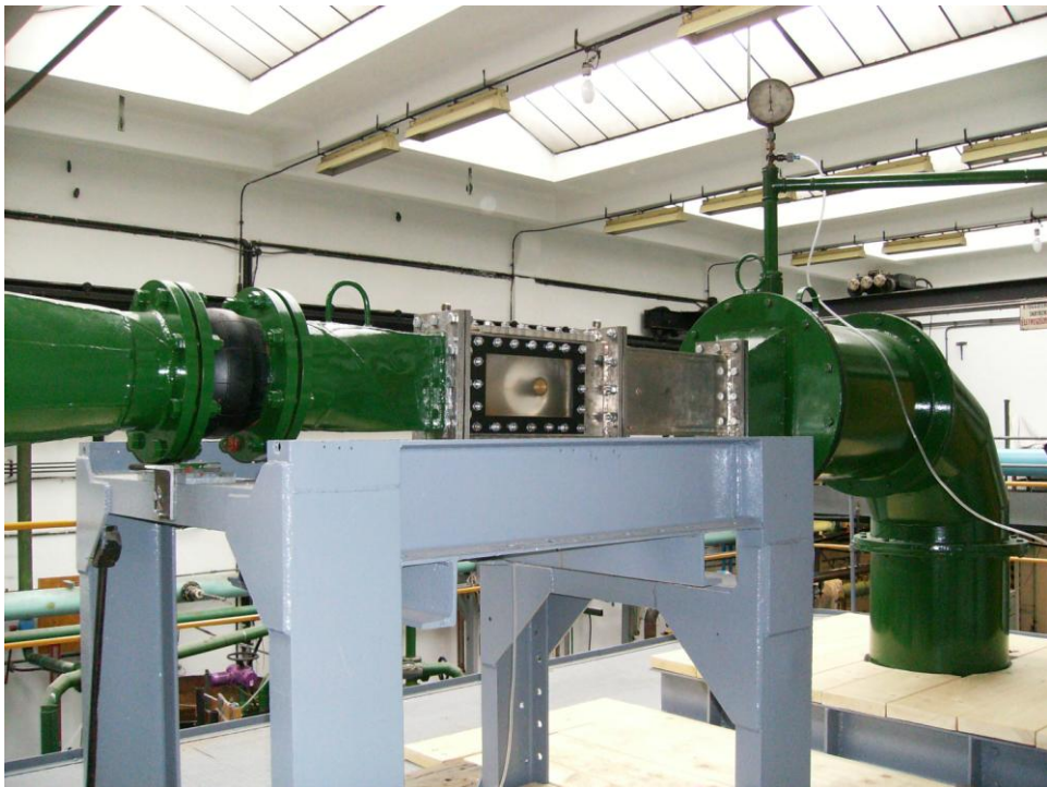
4. ábra A mérőszakasz (jobbra a terelő lapátos szegmensív) a plexifalú mérőtérrel
