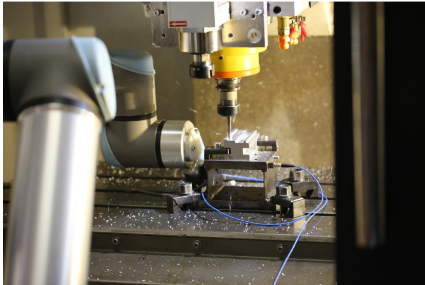
4. Ábra: Munkadarab forgácsolása 50 N támasztóerő mellett.
