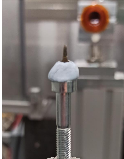
6. ábra Próbatest és rögzítése a szinkrotron nyaláb útjában a 360°-os forgatás előtt
