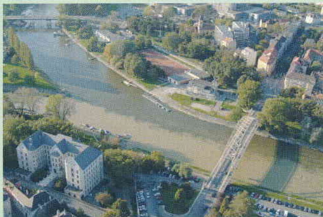
A vörösiszap semlegesítésére használt gipszet szállító víz a Rábán keresztül eléri a Mosoni-Duna vizét és jól láthatóvá teszi az összefolyásnál kialakuló bonyolult örvények elkeverő hatását (Örvénydinamika és kaotikus elkeveredés folyami áramlásokban című cikkünkhöz – 33. oldal)
