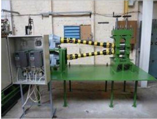
2.2 ábra. Kísérleti hengerállvány szimmetrikus és aszimmetrikus hengerléshez
